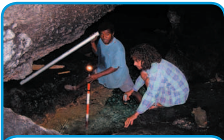
Travaux de topographie pour la mise en place d'un enregistreur de niveau d'eau dans la grotte de Manedj, Lifou
